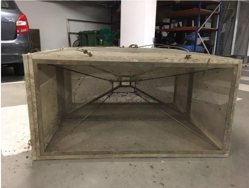
Figuur 21 – voorbeeld van een glasaalfuik met 2 compartimenten die kan gebruikt worden om migratie van glasaal te bemonsteren.
