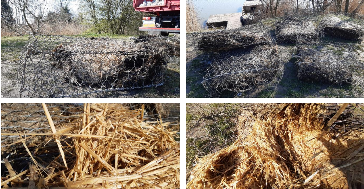
Figuur 13: Oude schanskorven met stro van het experiment uit 2020 die bij aanvang van het experiment in maart 2021 verwijderd werden uit het bekken. Boven: schanskorven met het stro. Onder: het oude stro lijkt binnenin nog in goede staat wanneer de pak opengetrokken wordt.
