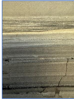
Figuur 2 : gelaagde structuur van hydraulische gestorte vliegastof (afmeting 7 cm x 5 cm)
