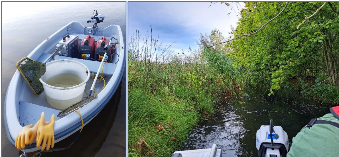
Figuur 3: Links: Illustratieve foto van het materiaal voor elektrisch afvissen. Achteraan de generatoren en transformator, centraal in de boot de kuip om de gevangen vis in te plaatsen, links ervan het schepnet en aan de rechterzijde de anode. Op de boeg liggen isolerende handschoenen. Rechts: Zicht tijdens afvissing traject 1 (locatie 675); meer bepaald in een zijwatergang. © Mechtild zoeter Vanpoucke, PCM.
