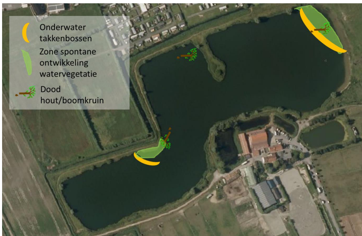
Figuur 5 – Aanbevolen zones voor spontane ontwikkeling van watervegetatie op basis van het diepteprofiel. Om deze zones te beschermen tegen golfslag en wind, wordt voorgesteld onder water takkenbossen aan te brengen die de golfslag breken.
