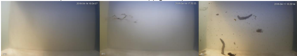
Figuur 12: Voorbeelden van “visloze” filmpjes. LINKS: getriggerd door “schitteringen” in het water waarbij de snel wisselende lichtinval de camera triggerde. MIDDEN en RECHTS: passerend plantaardig materiaal dat de camera triggert. Géén van deze resulteerde in een detectie. M.a.w. de software herkent dergelijke clips correct.
