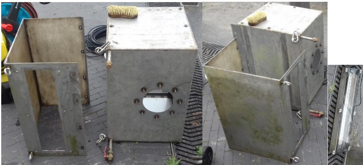
Figuur 10: Links en midden: gedemonteerde camerabox en zwemtunnel na reiniging met hogedruklans. Rechts: de lichtbak met ledverlichting die kunstlicht leverde voor de opstelling.
