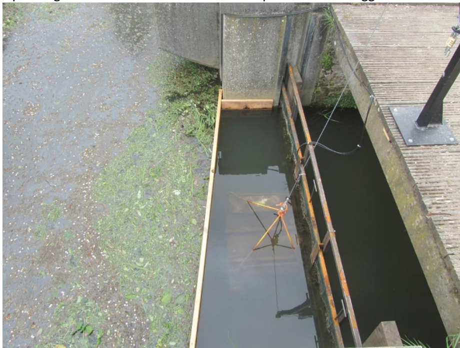
Figuur 5: Drijfbalk die gemonteerd werd drijvend debris, organisch materiaal en afval zo veel mogelijk tegen te houden zodat dit de bewegingssensor niet zou triggeren en dus het aantal "visloze" video-opnames terug te schreeven.
