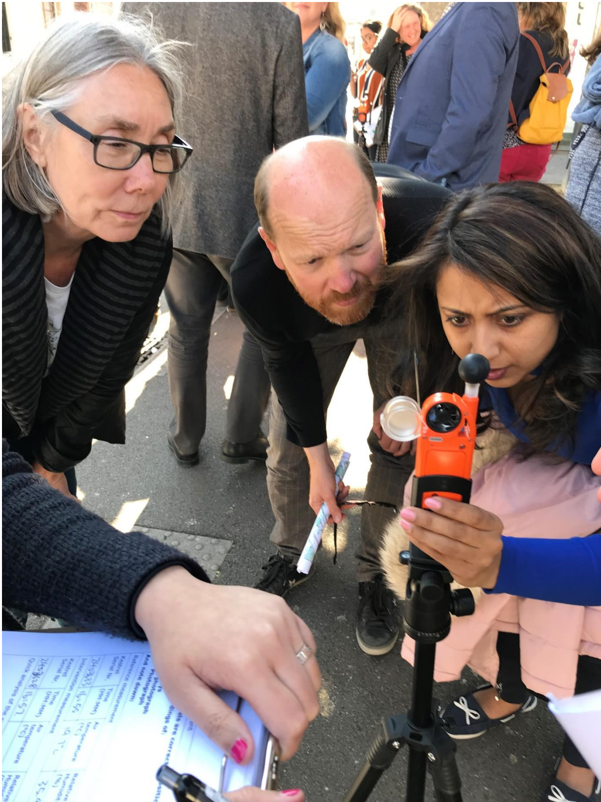
Figuur 16: Deelnemers die de meteorologische omstandigheden van de locatie meten met behulp van het mobiele weerstation Kestrel 5400 Heat Stress.
