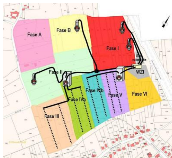
Figuur 8-3 // Schematische weergave verzamelnetwerk percolaat naar WZI stortplaats 'Deponie Vlierzele' (Bron: ontheffingsnota 'ILvA-Deponie Vlierzele' (april 2012))
