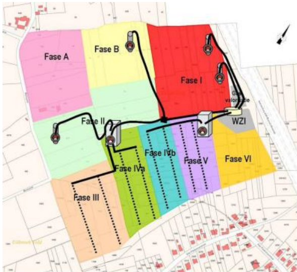
Figuur 7-2 // Schematische weergave verzamelnetwerk percolaat naar WZI stortplaats 'Deponie Vlierzele' (Bron: ontheffingsnota 'ILvA-Deponie Vlierzele' (april 2012))
