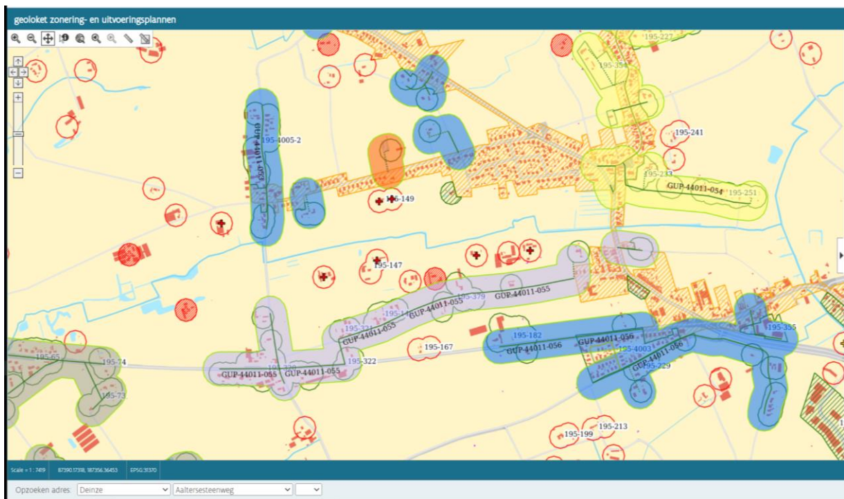
Figuur 5 – Overzicht van de uitvoerings- en zoneringsplannen met focus op de Maanbeek/Zeverenbeek te Deinze. De verschillende clusters duiden op resterende lozingen van huishoudelijk afvalwater die nog dienen afgekoppeld te worden.
