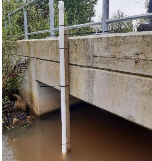
Figuur 4 – Foto van de peilbuis met diver die bevestigd werd aan de brug over de meander voor de opvolging van het waterpeil en de watertemperatuur in het Malesbroek.
