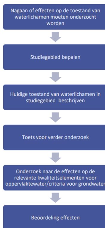
Figuur 1-1 : schematisch overzicht van de aanpak voor de beoordeling van de effecten op waterlichamen
