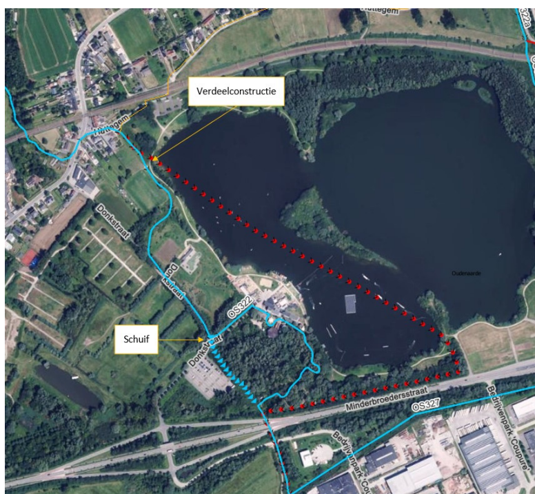
Figuur 11: Overzicht van de constructies op de Volkaartsbeek. In rode stippellijn is de oude loop weergegeven. De blauwe stippellijn geeft de waterloop weer die de provincie Oost-Vlaanderen heeft ingedeeld als waterloop van 2 de categorie.
