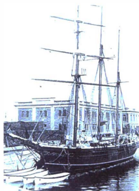
De 358 ton grote Ville d'Ostende een driemast-topzeilschoener werd in 1881 door de Belgische Staat bij Van Praet besteld
