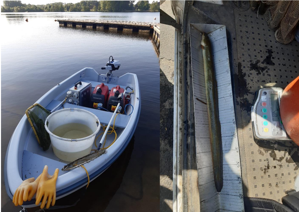
Figuur 2: Links: Boot met materiaal voor elektrisch afvissen. Achteraan de generatoren en transformator, centraal in de boot de kuip om de gevangen vis in te plaatsen, links ervan het schepnet en aan de rechterzijde de anode. Op de boeg liggen isolerende handschoenen. Rechts: paling die in de meetgoot ligt voor lengtebepaling. © Mechtild zoeter Vanpoucke, PCM.
