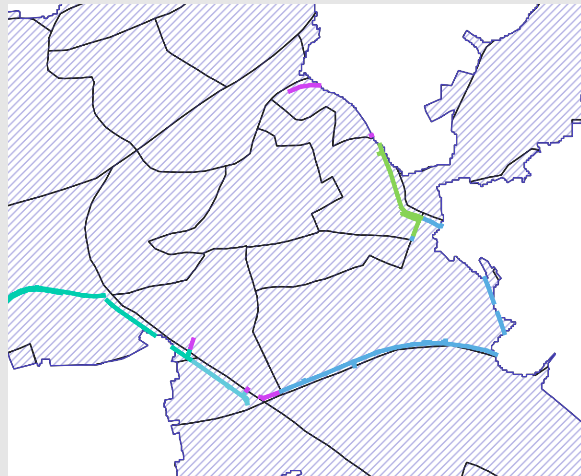
Figuur 5.20: Collector groep opgedeeld in verschillende stukken o.b.v. statistische sectoren. Elk stuk collector heeft een fractie van het totale potentieel o.b.v. de lengte van de collectorgroep per statistische sector t.o.v. de totale lengte van de collectorgroep
